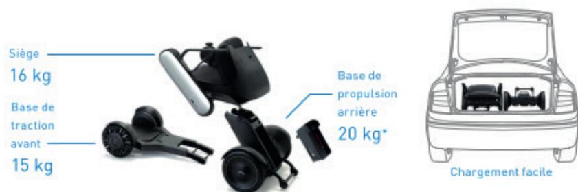
Sa taille compacte et ses roues omnidirectionnelles brevetées facilitent les déplacements dans les espaces exigus, tandis que les grandes roues et les deux moteurs puissants vous permettent de conduire sur les terrains accidentés en toute confiance.
